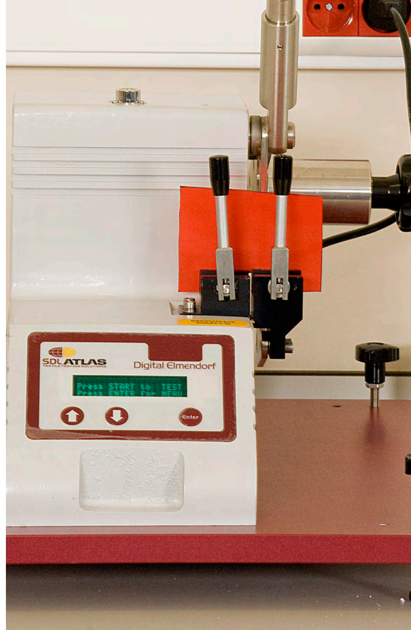
Elmendorf Yırtılma Mukavemet Test Cihazı Sarkaç yöntemi ile kumaşların yırtılma mukavemetinin ölçer.
