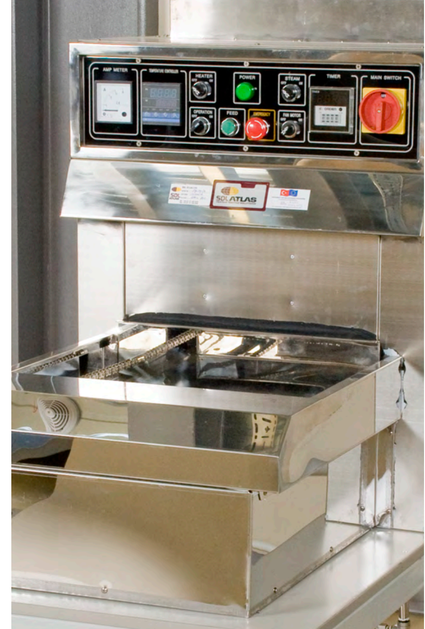
Laboratuvar Tipi Kurutme ve Buharlama Makinesi Laboratuvar uygulamalarında ısıfiksaj ve buhar fiksajında kullanılır.
