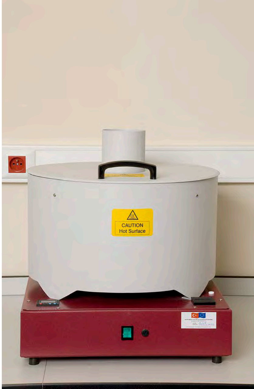
ATLAS Işık Haslık Test Cihazı Tekstil ürünlerinin kuru ortamda ışık ve UV haslık testlerinin tespitinde kullanılmaktadır.
