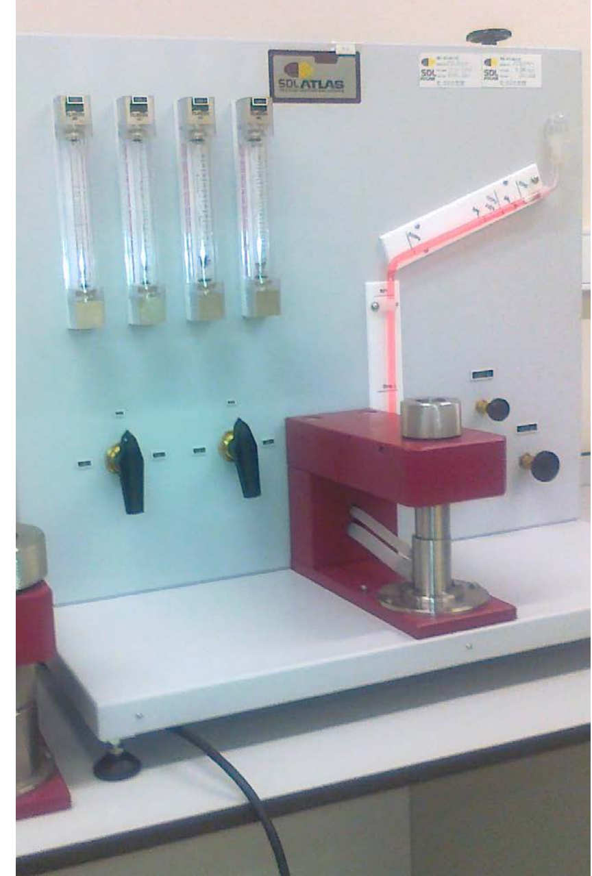
Hava Geçirgenliği Test Cihazı Kumaşın içerisinden hava geçişini ölçmede kullanılır.
